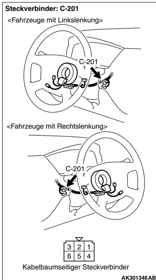
**SCHRITT 15.** Den Kabelbaum zwischen Steckverbinder C-201 (Klemme Nr. 2) des Zündschalters und Steckverbinder C-220 (Klemme Nr. 1) des Kraftstoffpumpenrelais (2) prüfen.
